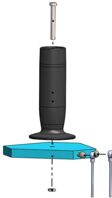
Figura 6.5 Montaje de la plataforma superior.
