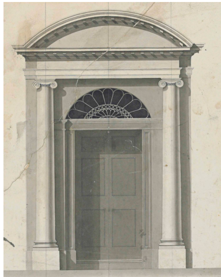
Fig. 12. Diseño de Robert Adam de una puerta principal neoclásica, con columnas jónicas y un frontón circular. También puede verse el gran tragaluz en forma de abanico, característico de dicha época.
