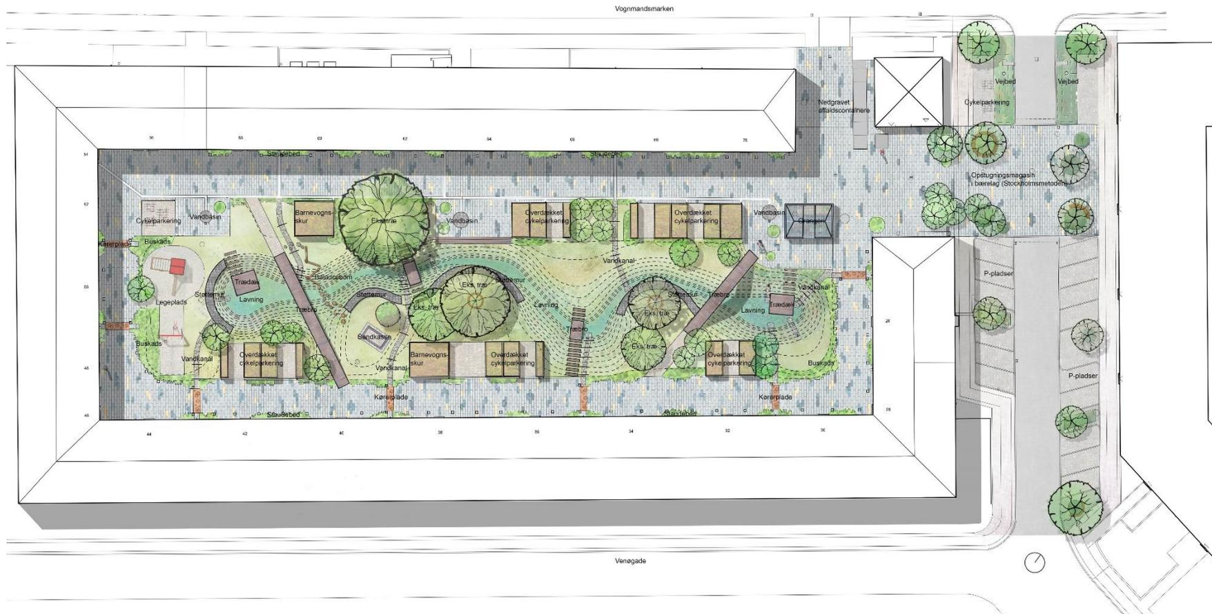
El agua de lluvia de los tejados es conducida a través de canalones hasta el foso situado en el centro del patio, desde donde se filtra. La zanja también puede recoger y retener tormentas extremas, de modo que se alivian las alcantarillas de la ciudad. Esto limita la inundación de sótanos y edificios (Klimakvarter, s/f<sub>6</sub>).
