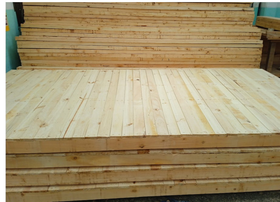
Fig. 29 Acopio de los paneles de piso una vez finalizados. Elaboración propia.
