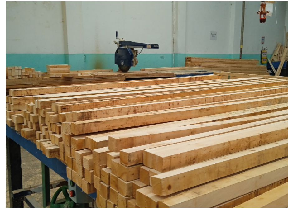
Fig. 27 Vigas de piso acopiadas en la fábrica. Elaboración propia.
