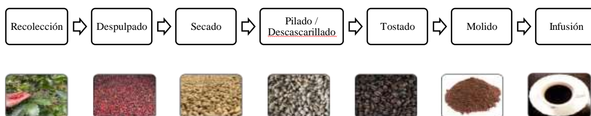
FIGURA 2. Proceso de las diferentes etapas desde la recolección del café hasta la obtención de la infusión
