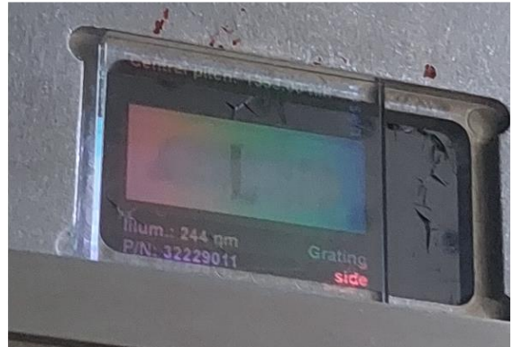
Figura 21. Izquierda: Sistema óptico empleado durante el proceso de grabado de films de hidrogel. Derecha: máscara de fase que genera el patrón de interferencia constructiva-destructiva en el film de hidrogel.
