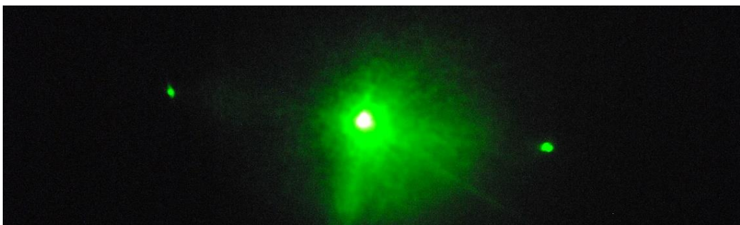
Figura 22. Patrón de difracción producido por la red de volumen (VHG) generada en el film de hidrogel.
