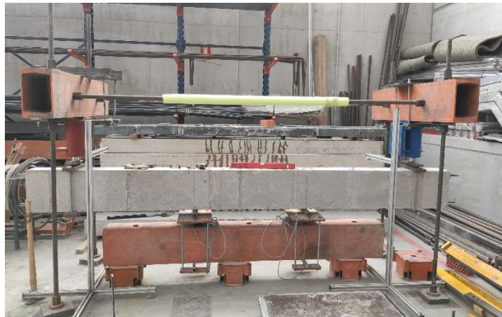
Figura 14. Montaje del ensayo. Viga en carga. Fuente: elaboración propia.
