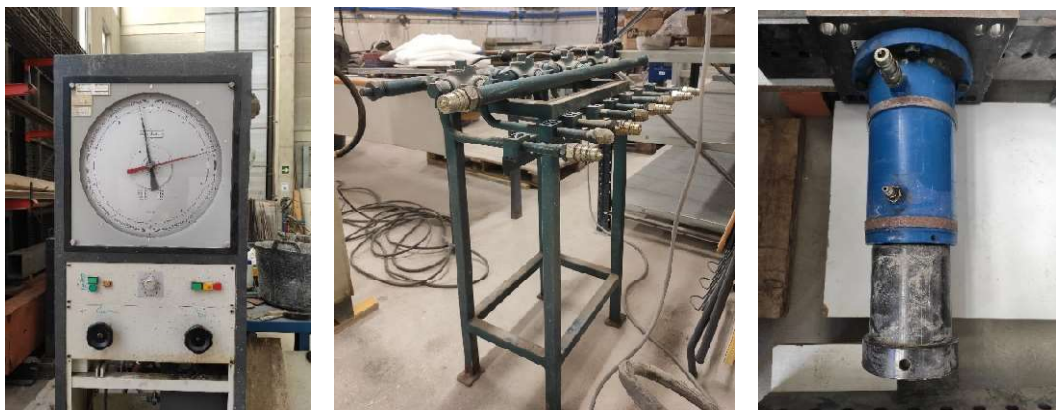
Figura 11. Equipo de presión, distribuidor de aceite y actuador hidráulico. Fuente: Elaboración propia.
