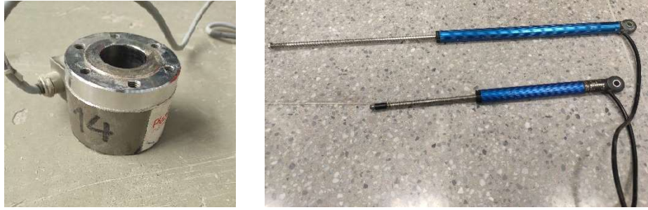
Figura 13. Galga de captación de carga y captador de desplazamiento. Fuente: elaboración propia.
