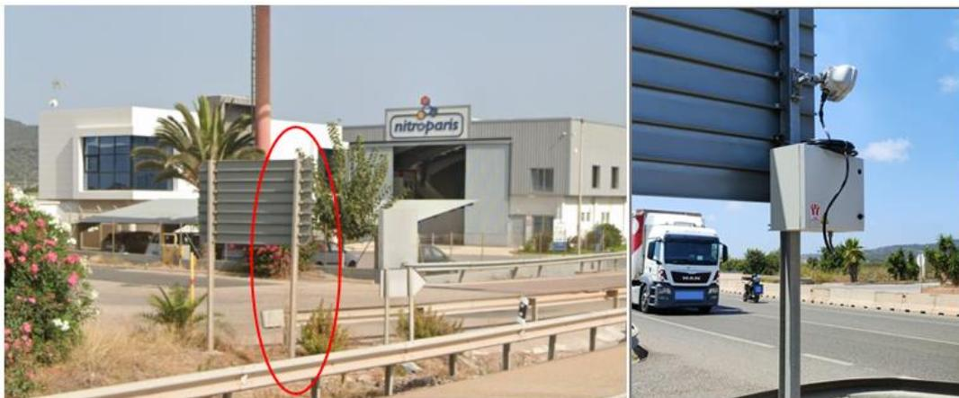
**Ilustración 29: Punto de instalación radar aforador lateral. Fuente: CPS**
