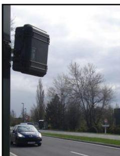
**Ilustración 9. Instalación ejemplo aforador microondas. Fuente: Quadrex.**
