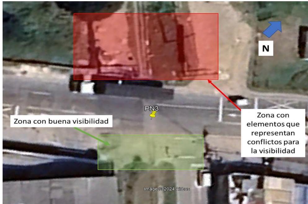
Figura 35. Inspección virtual del PPNN 3
