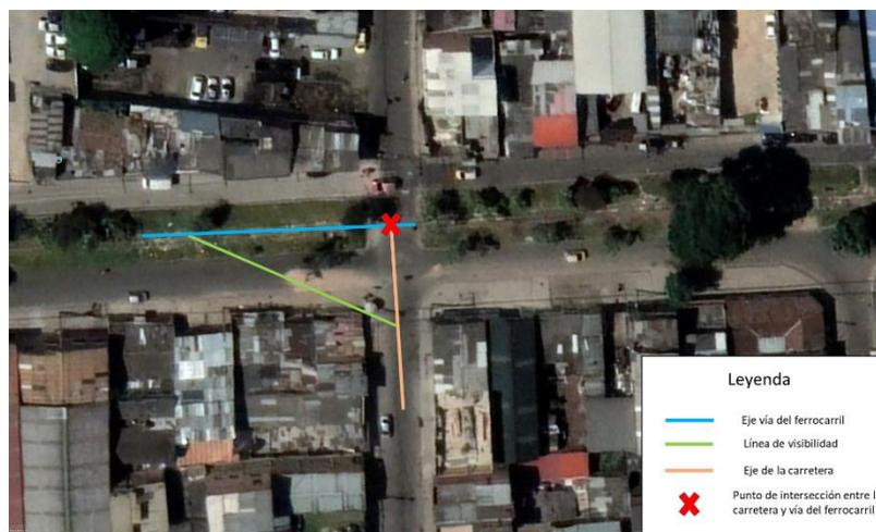
Figura 6. Establecimiento de la intersección entre el eje de la carretera y el eje de la vía del ferrocarril. Fuente: Elaboración propia a partir de Google Earth.
