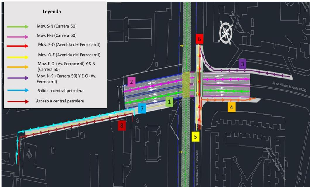
Figura 51. Solución a los movimientos vehiculares existente en el PPNN 15. Fuente: Elaboración propia.
