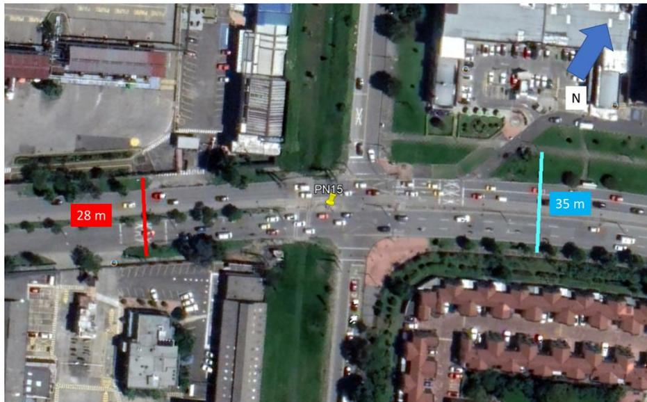
Figura 48. Sección transversal disponible para la construcción del paso inferior y reconfiguración de viales. Fuente: Elaboración propia.
