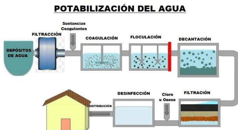
Figura 2. Estructura general de una planta potabilizadora. ( https://www.areaciencias.com/biologia/potabilizacionydepuraciondelagua/ )
