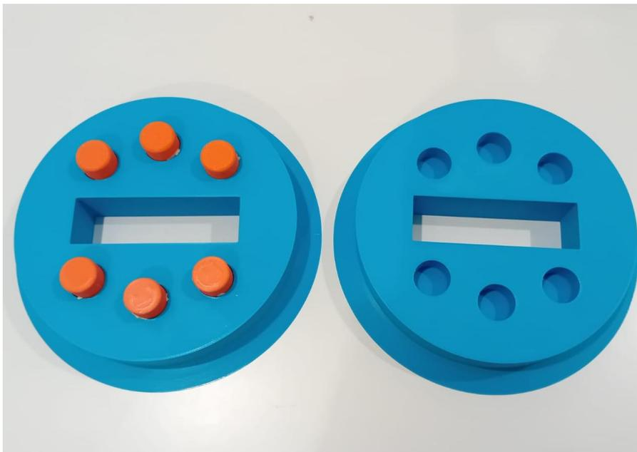
*Ilustración 11: Rueda principal por partes impresa 1*
