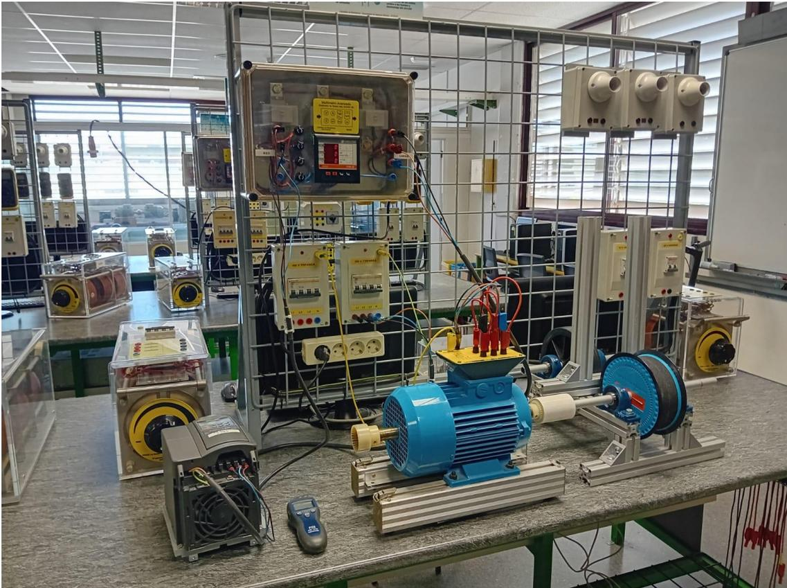
*Ilustración 22: Ensayo cálculo de pérdidas en los rodamientos*
