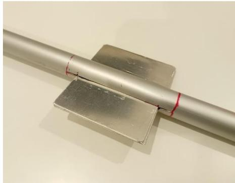
*Ilustración 19: Encaje rueda principal con el eje 1*
