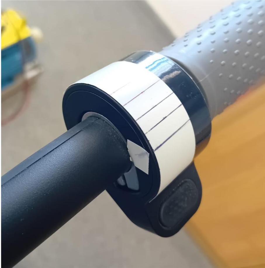
*Ilustración 27: Marcas en el acelerador del patinete eléctrico*
