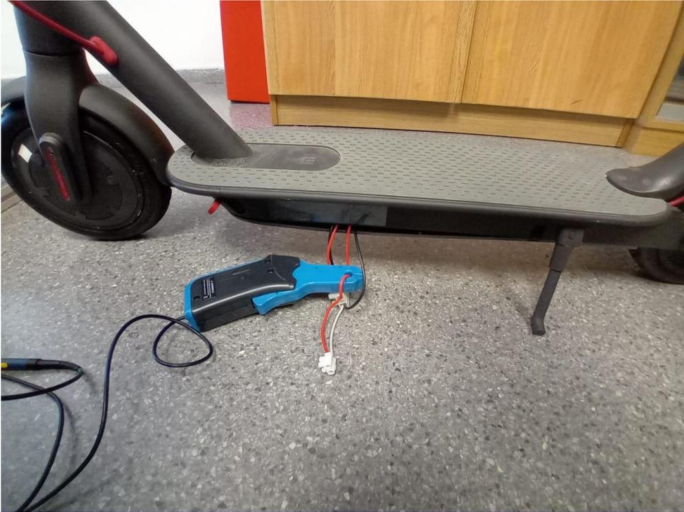
*Ilustración 26: Patinete eléctrico con equipos de medida a la salida de la batería 2*
