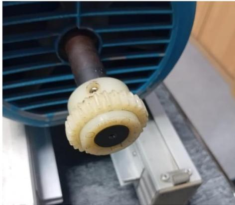
*Ilustración 4: Engranaje acoples máquinas*
