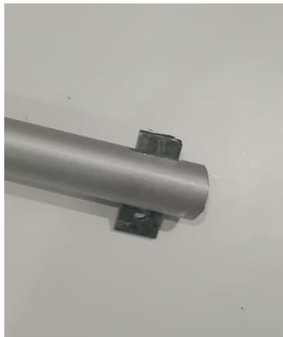
*Ilustración 18: Encaje pieza acople con el eje 2*
