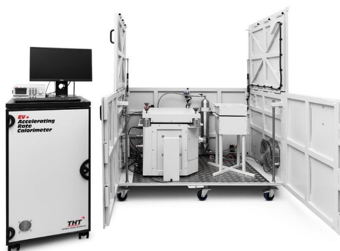
Fig. 17: Equipo ARC utilizado (EV+ de THT).
