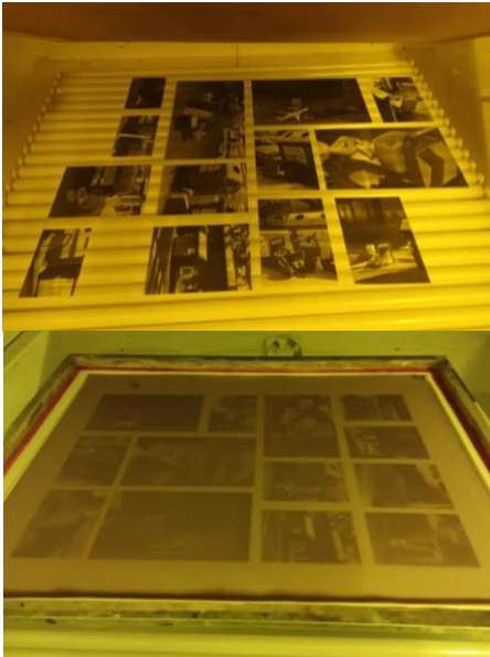
Fig. 29 y 30 Proceso de insolación de la pantalla. Laboratorio de Serigrafía, Facultad de Bellas Artes.
