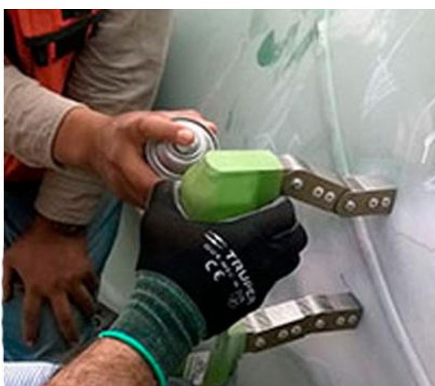
Ilustración 12. Técnica de inspección con partículas magnéticas. Fuente: SCI (2024).
