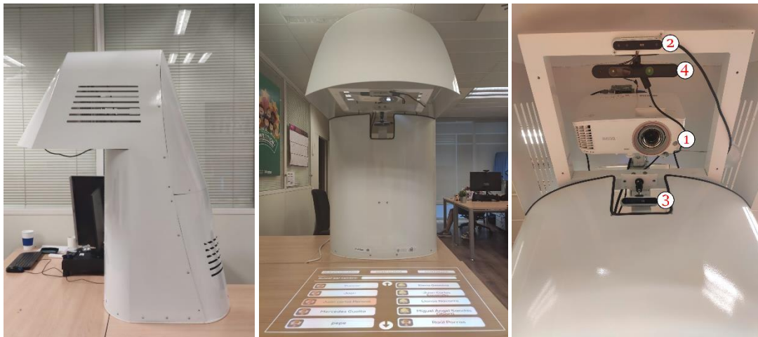
Figura 7. Prototipo del sistema de realidad virtual. En la parte superior de la estructura se encuentra el proyector (1), las cámaras de profundidad Intel Realsense D415 (2)(3) y la cámara Carmine (4).
