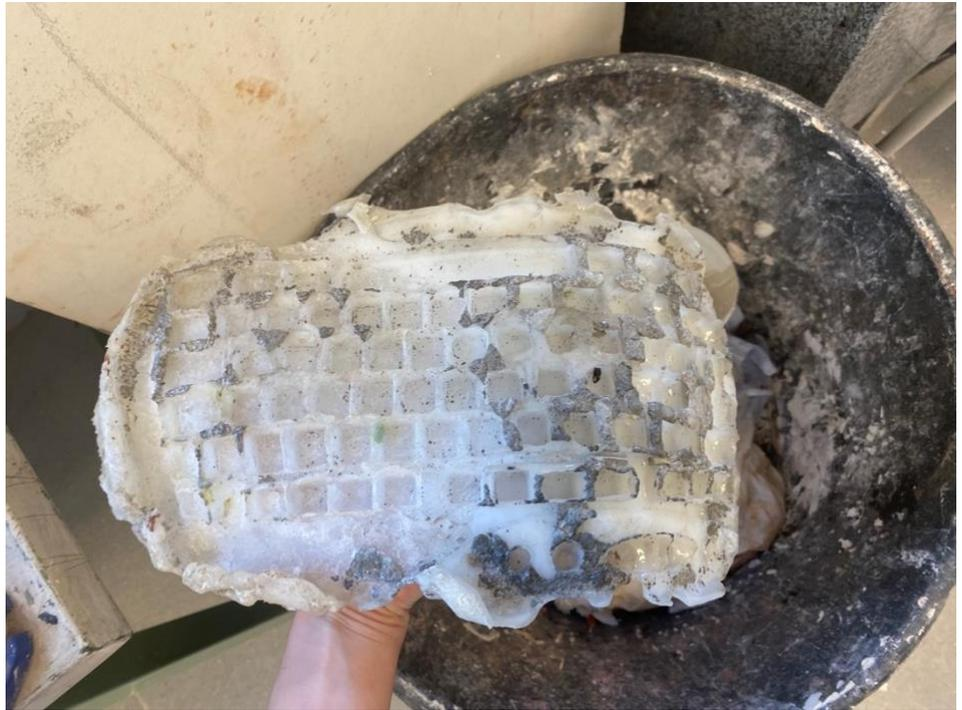
Figura 12 Molde de un teclado con silicona de juntas
