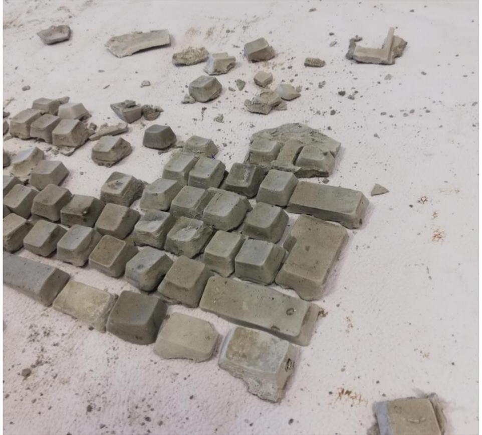
**Figura 11** Experimentaciones. Reproducción de un teclado a partir de un molde de silicona
