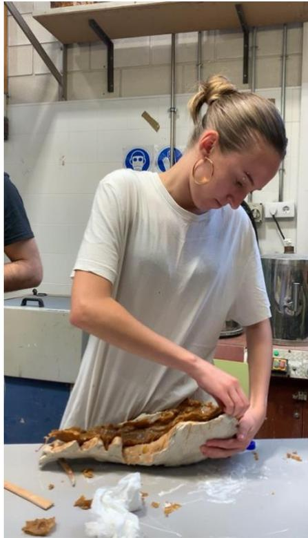
**Figura 6** Proceso de positivado en cera a partir de un molde de escayola
