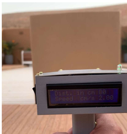
Figura 48. Prueba 2 (distancia de medida) Fuente: Elaboración propia
