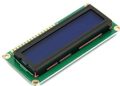
Figura 12. Adafruit Standard LCD 16x2 Fuente: Referencia bibliográfica [24]
