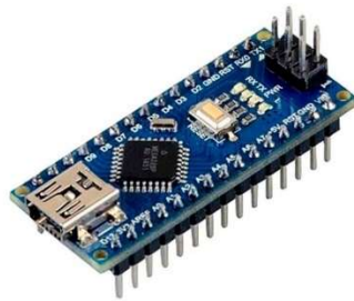
Figura 11. Arduino nano R3 Fuente: Referencia bibliográfica [23]
