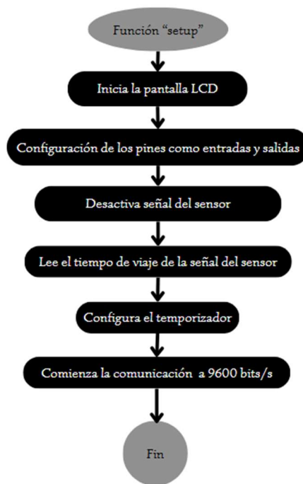
Figura 24. Diagrama de flujo función "setup" Fuente: Elaboración propia
