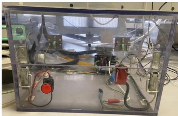
**Figura 8.** Cámara de tratamiento del equipo PEF.
