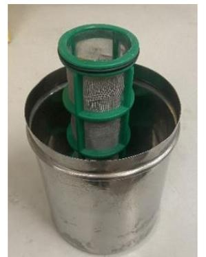
**Figura 4.** Recipiente y cestillo donde se introduce la muestra para prensar y recoger el zumo.
