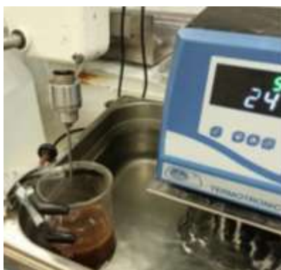
Figura 3. Montaje experimental para las cinéticas de extracción asistidas por agitación mecánica
