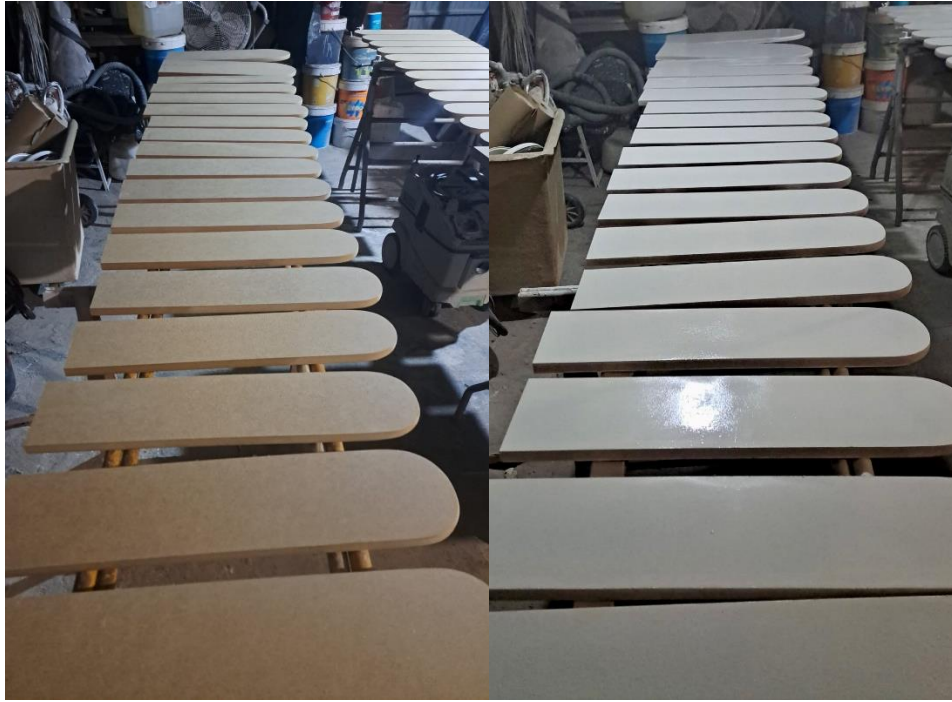
Figura 155. Preparado y primera capa de imprimación
