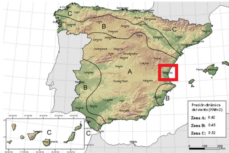
Figura 58. Pressió dinàmica del vent (kN/m 2 ) Font: DB-SE-AE.
