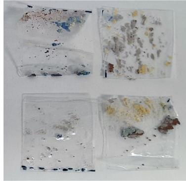
Fig. 223. Cuatro fragmentos de cinta adhesiva empleada para las mediciones finales del *Scotch Tape Test* en la franja consolidada con funori en polvo al 2,5% en agua de la probeta G2p3.
