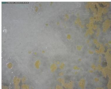
Fig. 246. Microfotografía tomada con el Dino-lite®. Detalle de un fragmento de cinta adhesiva empleada para las mediciones finales del *Scotch Tape Test*. Probeta G3p3.
