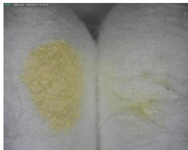
Fig. 200. Fluoline® CP. Izquierda: antes; derecha: después de 1 aplicación. Probeta G2p2.
