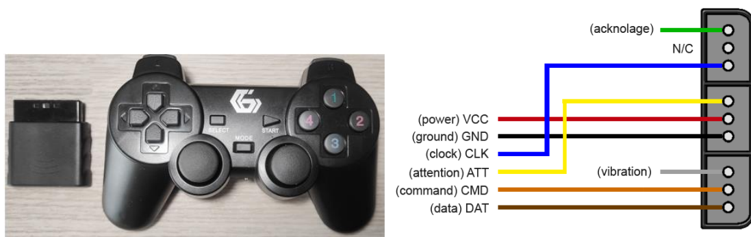
Figura 19 Conjunto de controlador/receptor y diagrama de pines de conexión del receptor de radiofrecuencia del mando de la PS2
