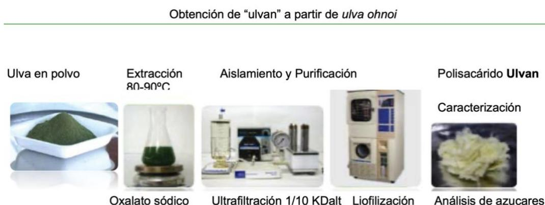
Figura 11. Proceso de obtención y aislamiento del polisacárido ulvan.
