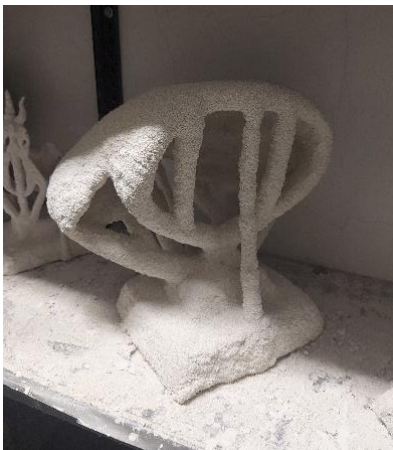
Fig. 21: Molde de cáscara cerámica en el respiradero.
