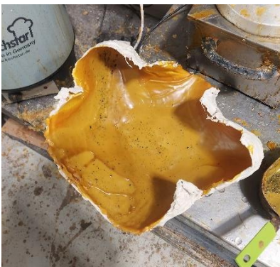
Fig. 16: Vertido de cera en el molde de escayola.
