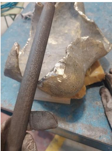
Fig. 26: Limado de la pieza.
