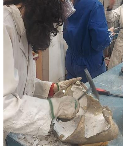
Fig. 24: Retirando el molde con un pico.
