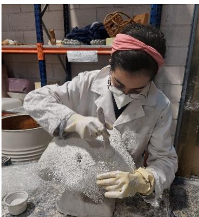
Fig. 22: Dando una capa de fibra de vidrio al molde.
