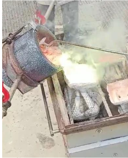
Fig. 23: Fundición de la pieza en latón durante el día de la colada.
