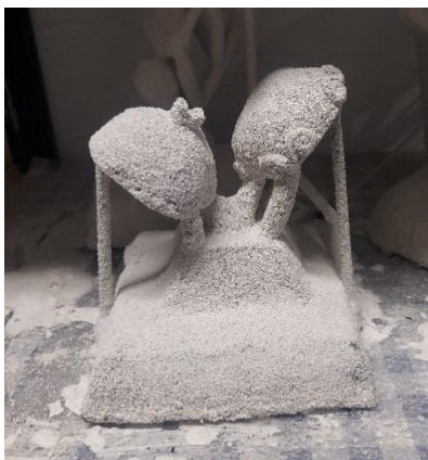
Fig. 42: Preparación del molde de cáscara cerámica.
