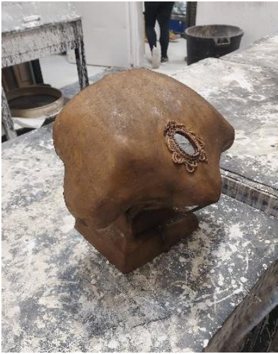
Fig. 20: El modelo con una capa de goma laca.
