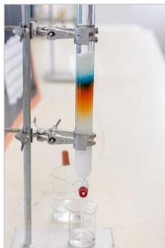
Figura 4.15. Cromatografía de columna
