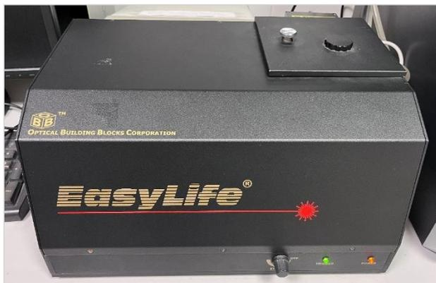
Figura 4.14. Equipo utilizado para la medida del tiempo de vida de fluorescencia
