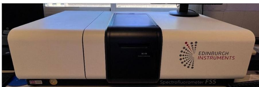
Figura 4.13. Espectrofotómetro utilizado para la medida de fluorescencia en estado estacionario
