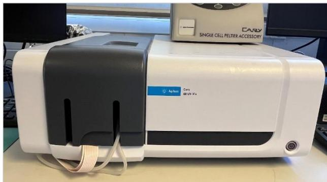
Figura 4.12. Espectrofotómetro utilizado para medir las bandas de absorción
