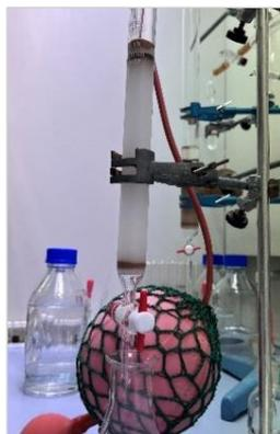
Figura 6.9. Columna para la separación del compuesto **2c**
