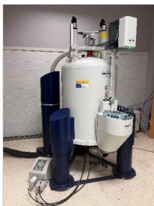
Figura 4.11. Equipo de RMN utilizado; 400 MHz
