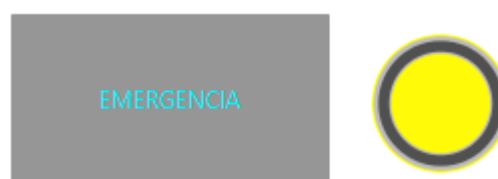
Figura 82. Botón de emergencia pulsado (izq) y luz de emergencia activa (dcha).
