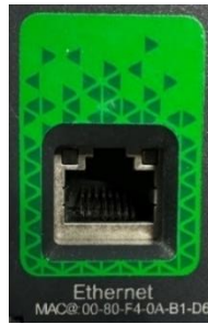
Figura 26. Conexión Ethernet del PLC.
