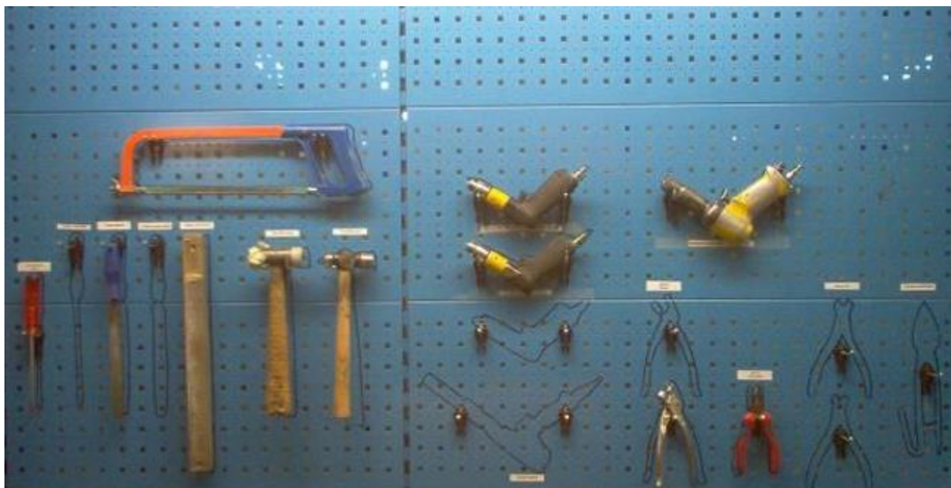
Ilustración 18: Herramientas colocadas en su contorno indicado en un banco de trabajo
