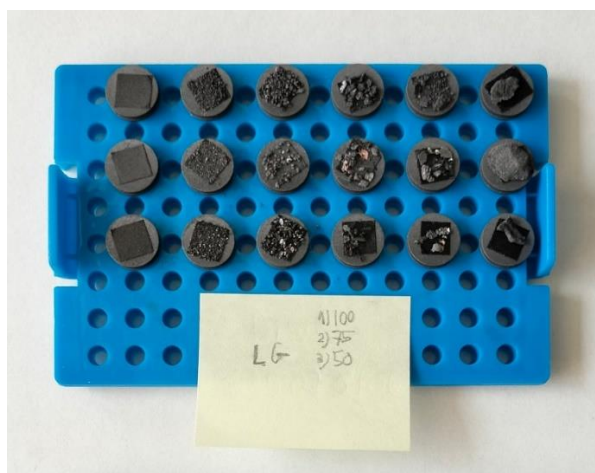
Ilustración 15. Muestras para FESEM en portamuestras de carbono
