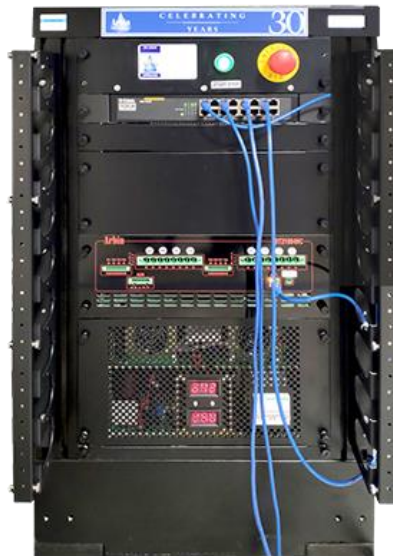
Ilustración 7. Fuente bidireccional Arbin LBT21084HC [44]
