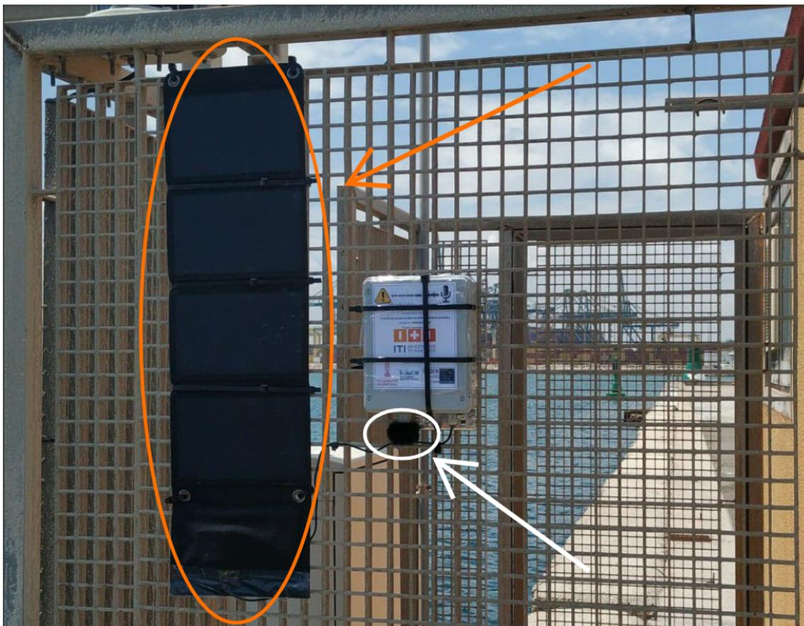
**Figura 3.3:** Foto de un nodo desplegado en el puerto de Valencia en el muelle de la Xità, donde la flecha naranja apunta a los paneles solares y la blanca al micrófono.
