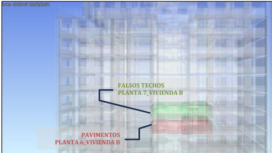
Figura 69: Simulación de detección de interferencias. Falso techo vs Pav. cerámicos. Planta 7.
