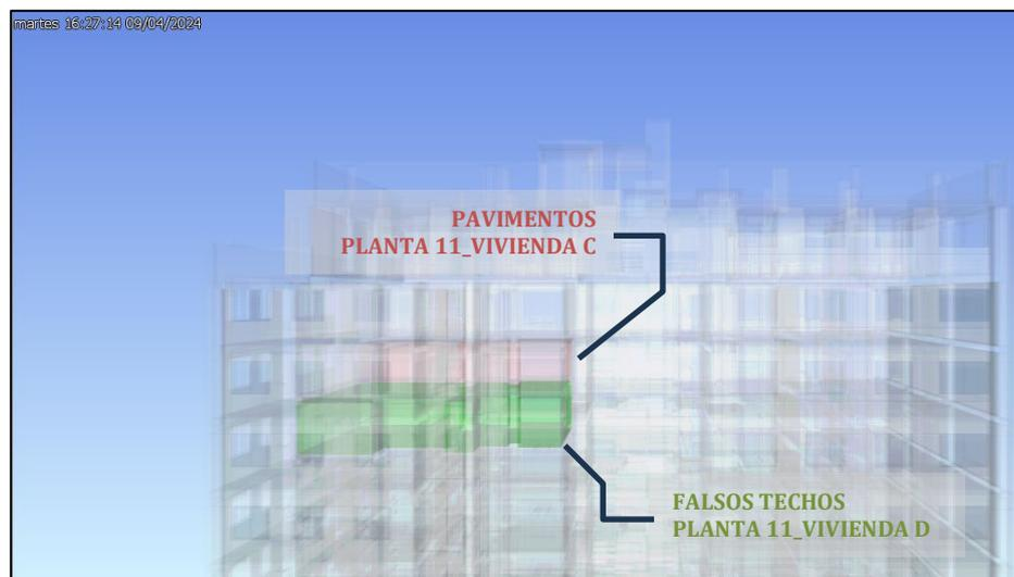
Figura 74: Simulación de detección de interferencias. Falsos techos vs Pav. cerámicos. Planta 11.
