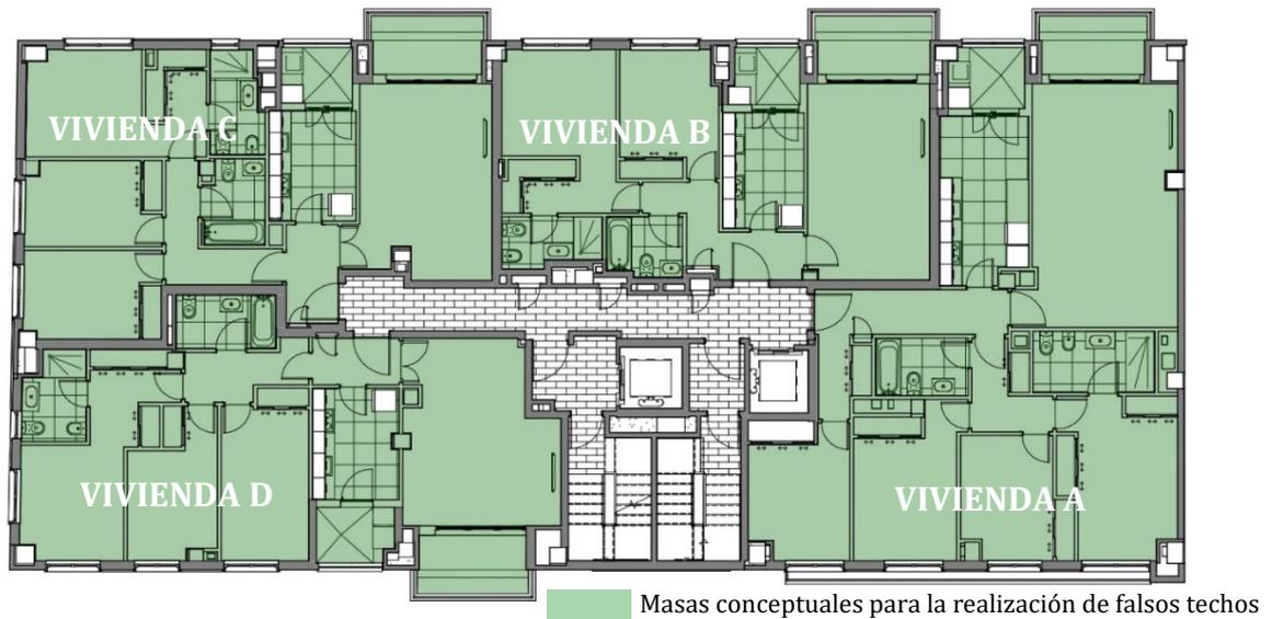
Figura 64: Masas conceptuales que representan el área que ocupa el equipo de trabajo para la realización de falsos techos en una planta tipo.
