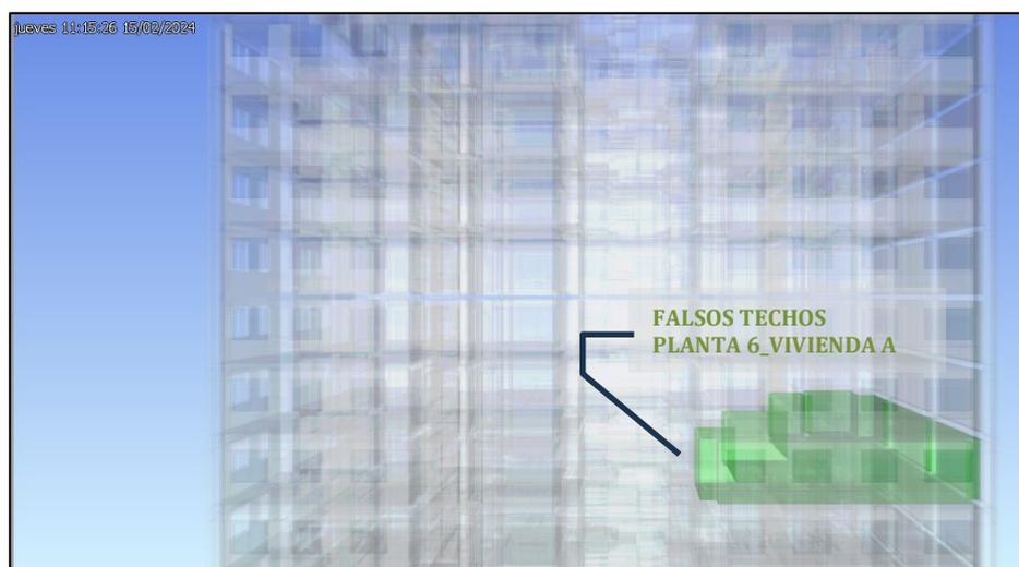
Figura 68: Simulación de detección de interferencias. Falsos techos vs Pav. cerámicos. Planta 6.
