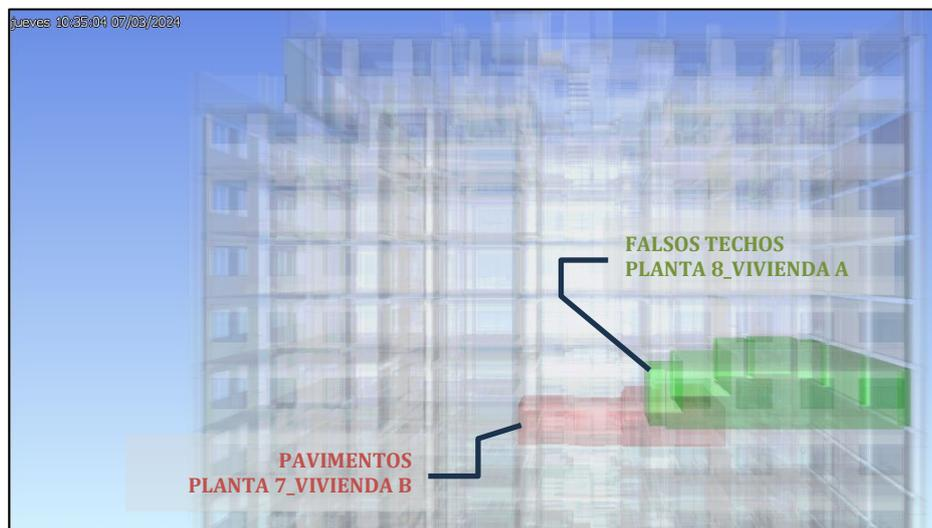
Figura 70: Simulación de detección de interferencias. Falsos techos vs Pav. cerámicos. Planta 8.
