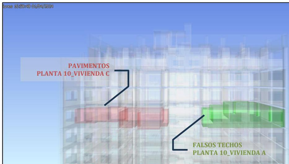
Figura 73: Simulación de detección de interferencias. Falsos techos vs Pav. cerámicos. Planta 10.
