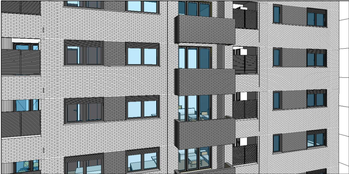
Figura 19: Vista 3D de una sección de la fachada en LOD 200.
