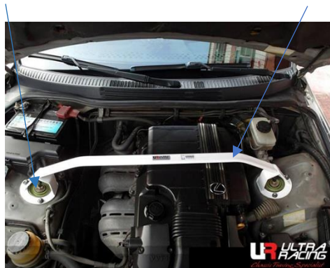
Imagen 18- Disposición de la barra de torretas delantera.
