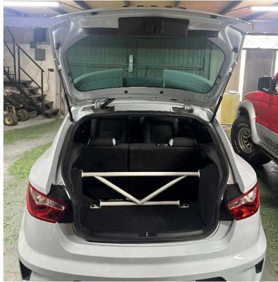
Imagen 70- Resultado final de la barra de torretas trasera. [Fuente propia]
