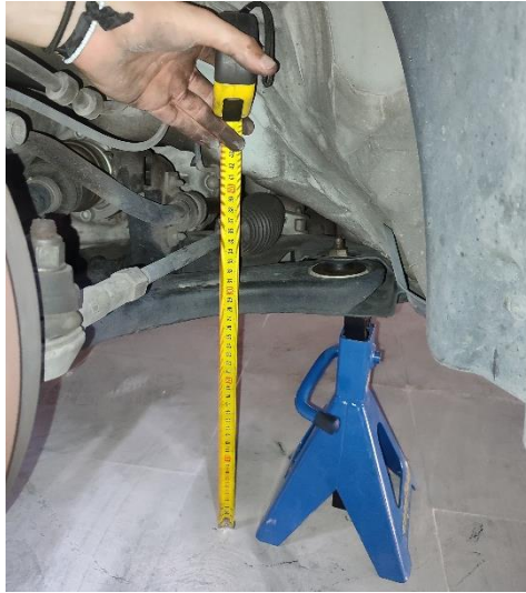
Imagen 31- Toma de medidas de las masas no suspendidas. [Fuente propia]
