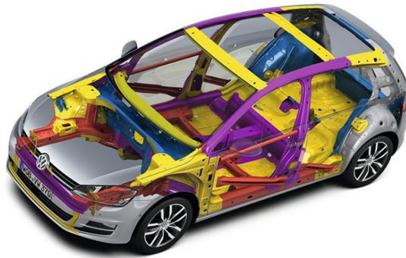
Imagen 15- Tipos de aceros utilizados en el chasis de un vehículo representados por colores.
