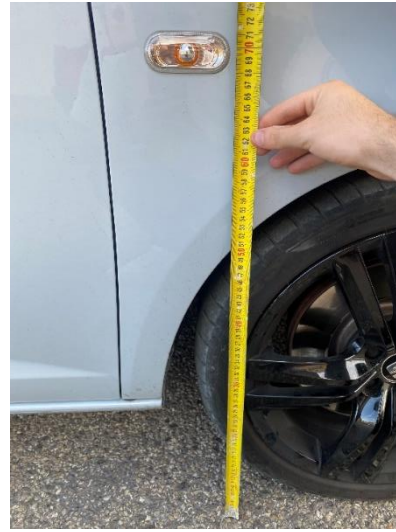
Imagen 125- Medición de la altura del intermitente lateral al suelo. [Fuente propia]
