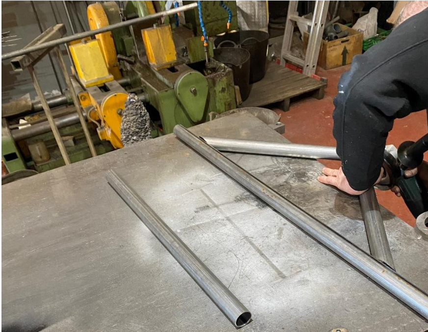
Imagen 57- Proceso de corte de las barras que conformarán la estructura. [Fuente propia]
