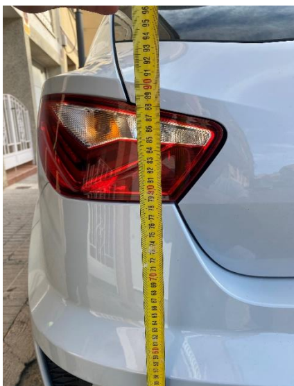
Imagen 127- Medición altura suelo-pilotos traseros (785 mm). [Fuente propia]
