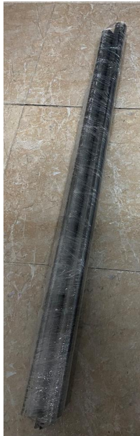
Imagen 56- Barras de acero de bajo carbono de 35 mm de diámetro. [Fuente propia]
