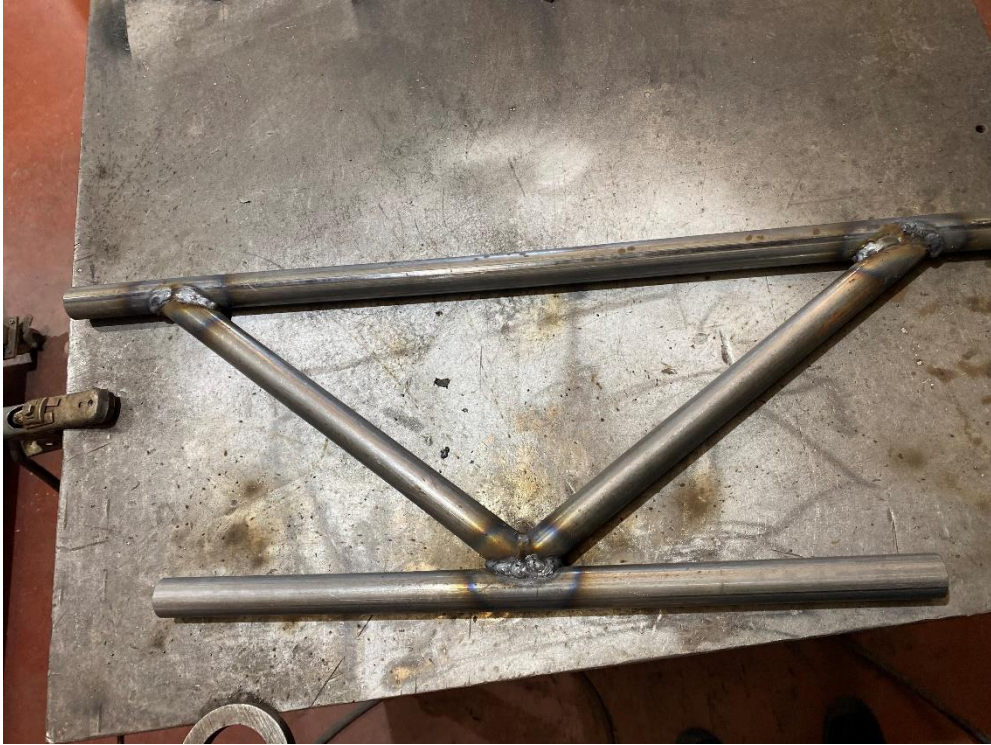
Imagen 60- Pieza soldada por profesional (con certificado de soldadura). [Fuente propia]
