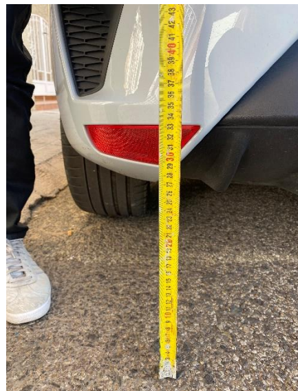
Imagen 128- Medición altura suelo-catadióptricos traseros (292 mm). [Fuente propia]
