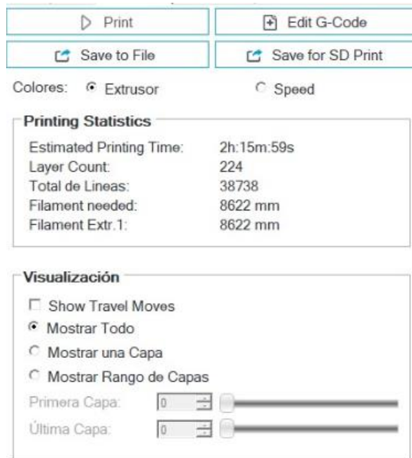
Imagen 62- Parámetros de impresión de CoLiDo (Software para previsualizar y cargar códigos de impresión). [Fuente propia]
