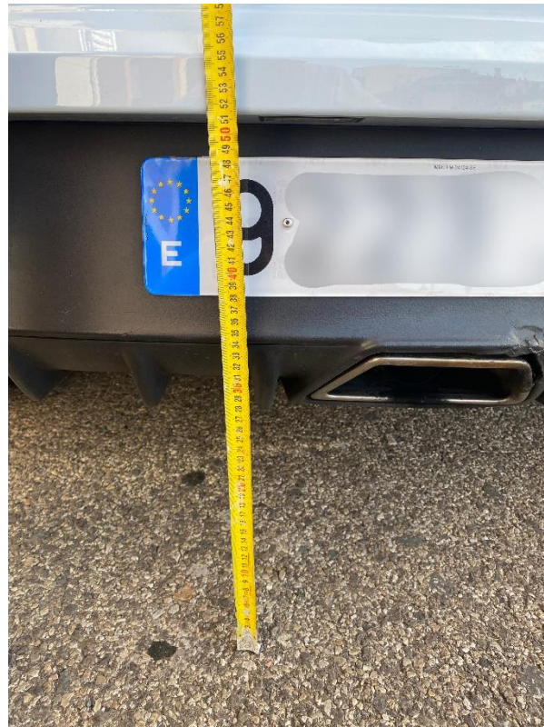
Imagen 129- Altura del suelo a la matrícula trasera (380 mm). [Fuente propia]
