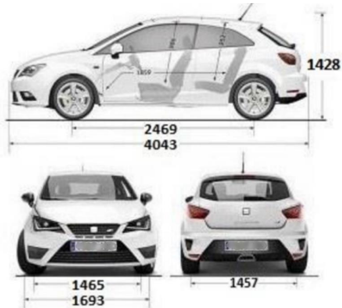
Imagen 115- Croquis acotado Seat Ibiza antes de la reforma.
