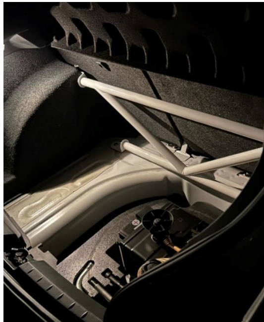
Imagen 69- Pieza atornillada al chasis del vehículo. [Fuente propia]
