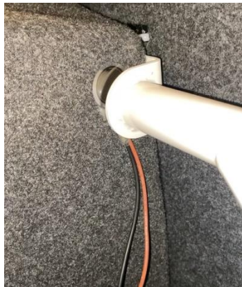
Imagen 76- Sensor colocado en la parte superior de la barra de torretas. [Fuente propia]
