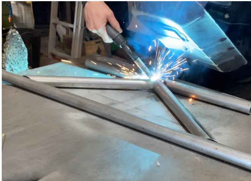
Imagen 59- Proceso de soldadura con hilo continuo. [Fuente propia]
