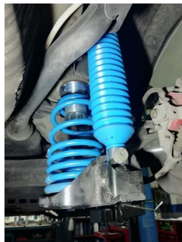
Imagen 118- Amortiguador y muelle trasero izquierdo. [Fuente propia]
