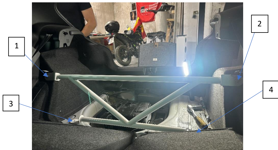
Imagen 67- Puntos en los que se amarrará la pieza. [Fuente propia]
