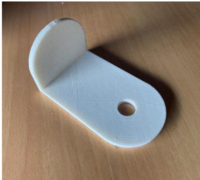
Imagen 65- Pieza de amarre de la barra de torretas (1) [Fuente propia]
