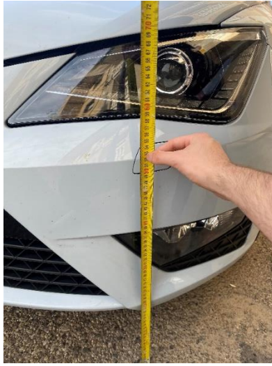
Imagen 126- Medición de la altura del suelo al faro delantero. [Fuente propia]
