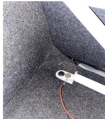
Imagen 75- Sensor colocado en la parte inferior de la barra de torretas. [Fuente propia]
