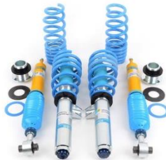
Imagen 9- Blistein B16 PSS10. (Nuevas suspensiones instaladas en el vehículo)
