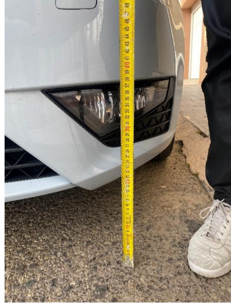
Imagen 123- Altura mínima de la luz antiniebla delantera. [Fuente propia]
