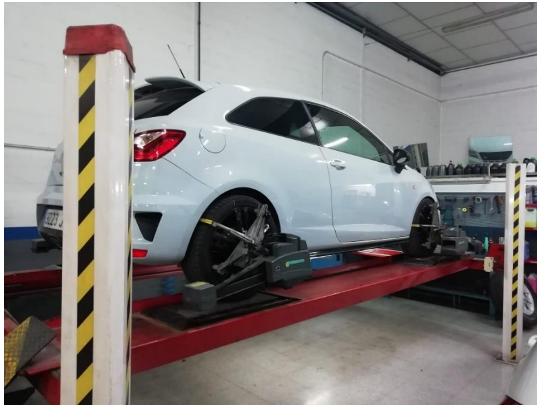
Imagen 28- Alineación y pesaje del vehículo por rueda. [Fuente propia
