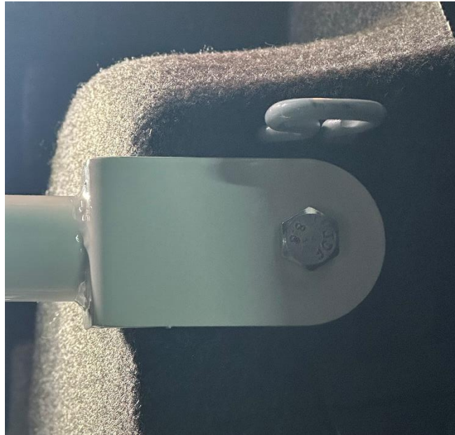
Imagen 68- Colocación de los tornillos para amarrar la pieza al chasis. [Fuente propia]
