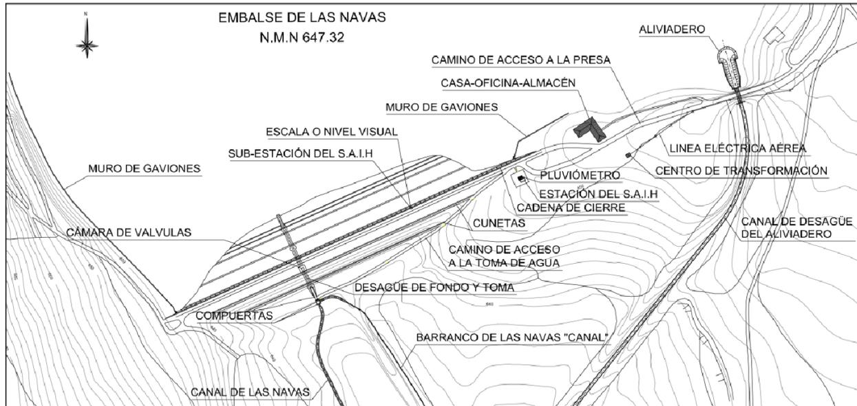
Figura 6.- Planta de la presa de Las Navas. Fuente: informe Anual de Inspección y Auscultación Años Hidrológicos 2019-2020 y 2020-2021 (Tyspa, 2022).
