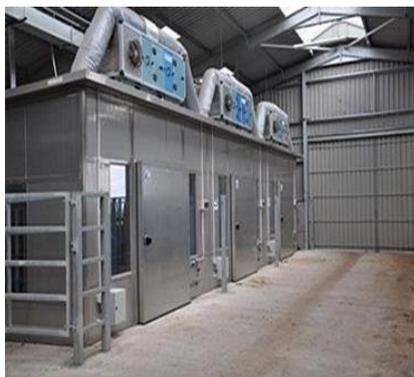
**Figura 6.** Fotografía de las cámaras de respiración de circuito abierto del *Scotland's Rural College, Edinburgh* (SRUC), utilizadas para obtener los datos de emisiones de metano de este trabajo.
