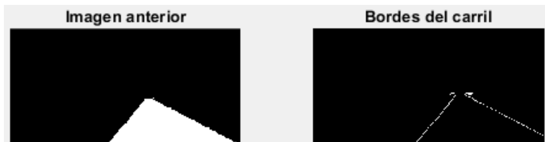
Figura 111. Implementación del algoritmo de Canny
