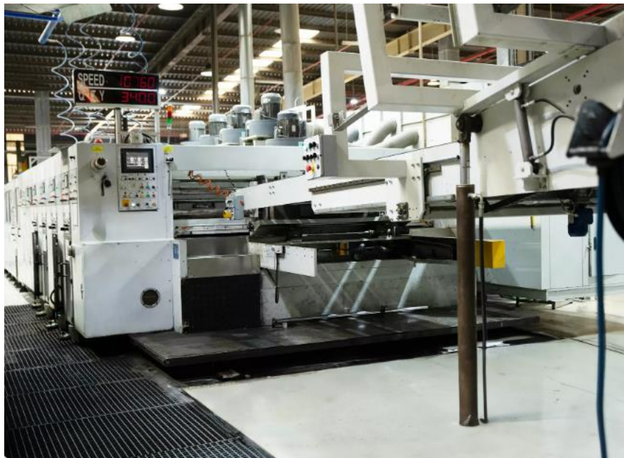
Imagen 127: Máquina casemaker Ondupack. Fuente: Ondupack.
