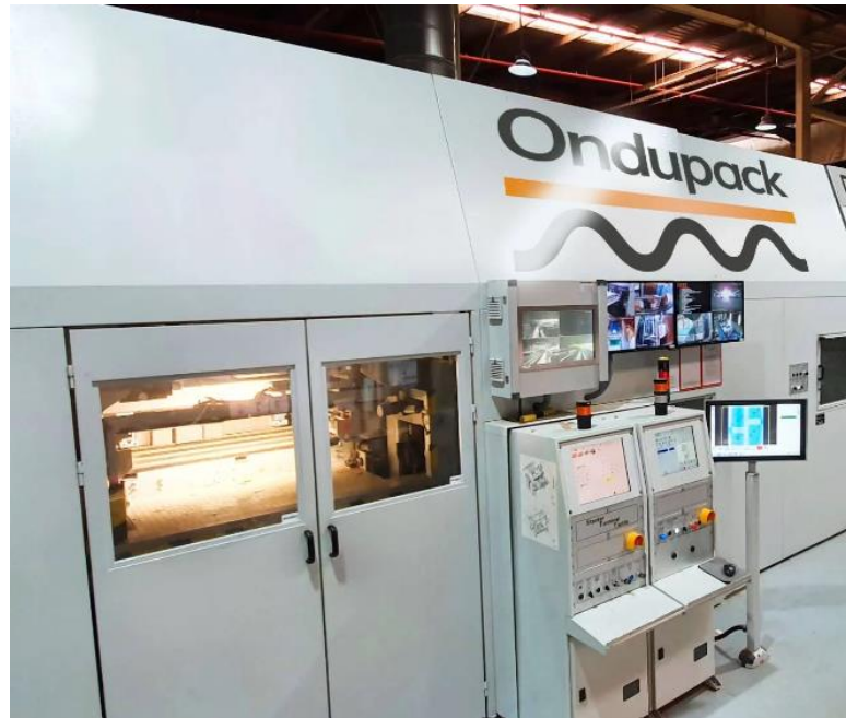
Imagen 126: Máquina troqueladora rotativa Ondupack. Fuente: Ondupack.
