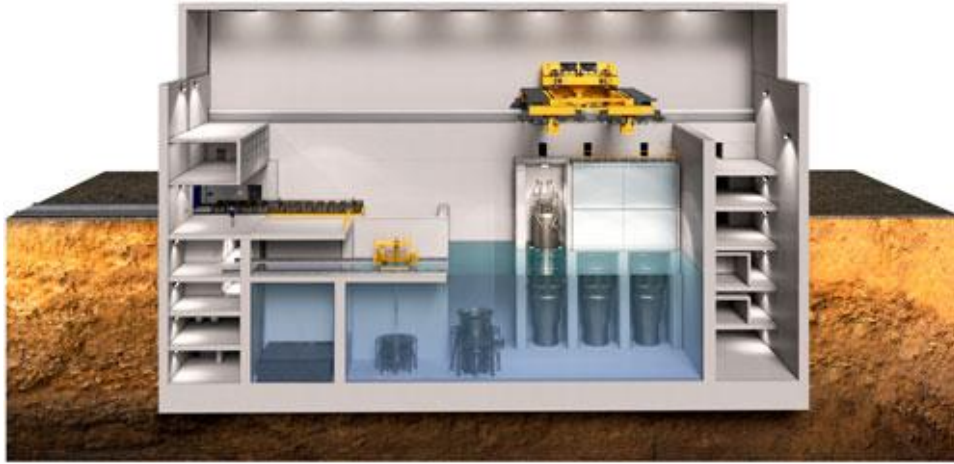
Figura 13. Edificio del reactor, donde se observa el módulo parcialmente sumergido (NuScale Power LLC, 2020).
