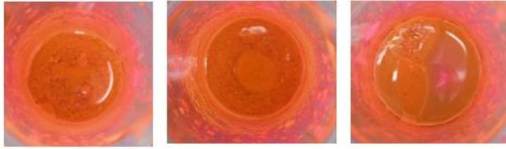
Figura 24. Resultado fallido de la emulsión en Ultra-Turrax (8 minutos a 10.000 rpm) de una disolución acuosa de rodamina a 1mg/mL sobre una disolución orgánica de PLLA y Span85 en diclorometano.
