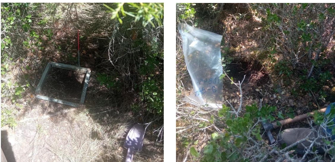
Figura 9. Muestreo del horizonte orgánico y del suelo mineral.
