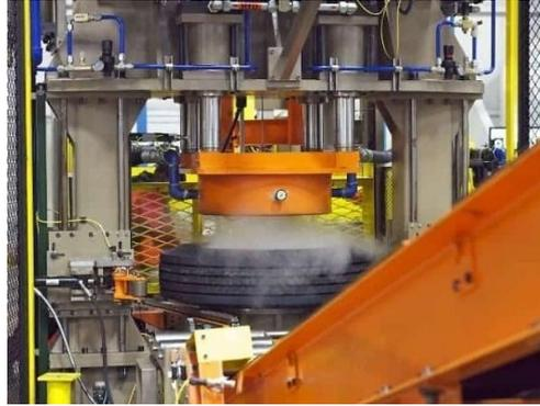
Figura 7. Máquina de ensamblado de neumáticos. Fuente (GoodYear)
