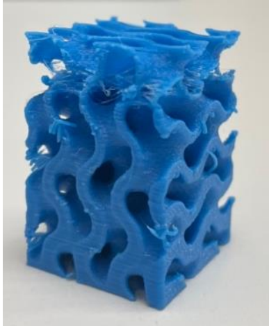
Figura 15: Estructura TPMS_Figura1_70_20 con defectos en la parte superior debido a la baja densidad y calidad de la impresión para los parámetros de prueba.
