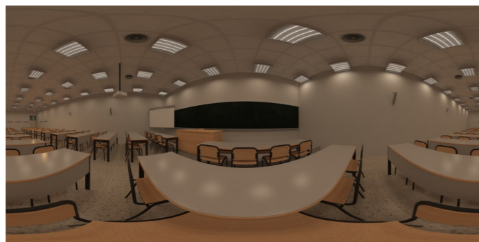
Figura 4. Replica virtual del aula base con las siguientes características físicas: color de pared blanco neutro (N5 en el sistema de color Munsell), altura, ancho y largo representativos de las aulas de la universidad (3,80 m × 8,40 m × 16,50 m) e iluminación artificial convencional (iluminancia 300lx, CCT 4000K, y flujo directo).
