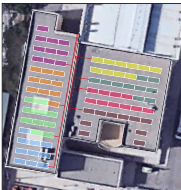
Figura 1. Planta general de la instalación fotovoltaica.
