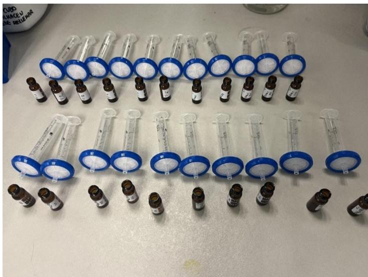
**Figura 6.** Filtración de los extractos derivatizados con filtros de jeringa de politetrafluoroetileno de tamaño de poro 0,45  $\mu\text{m}$
