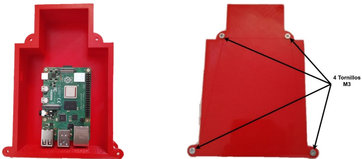
Figura 18: Resultado de la operación: a la izquierda la cara delantera y a la derecha la cara trasera con la ubicación y métrica de la tornillería empleada. Elaboración propia en Paint.
