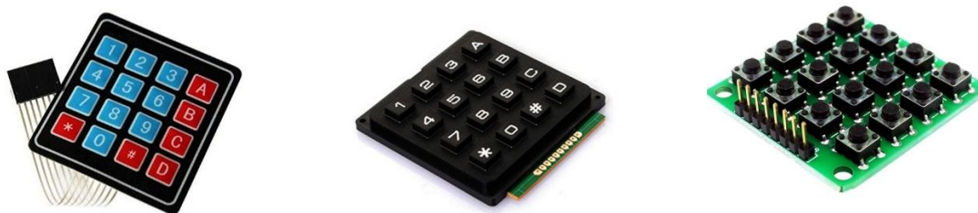
Figura 4: Teclados de tipo membrana, tecla y botonera, ordenado de izquierda a derecha. Imágenes extraídas del catálogo de Diatronic (2024) y Microlog (2024).
