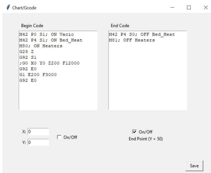
Figura 4.4: Ventana secundaria para modificar el inicio y el final del G-code.
