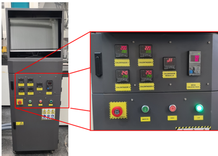
Figura 3.9: Estación de trabajo con vista detalle de los controladores y botones disponibles.
