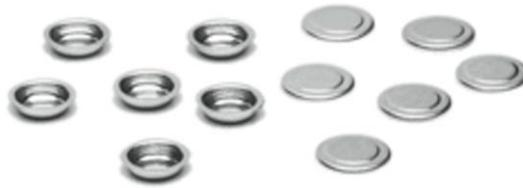
Figura 13. Crisoles propios del DSC 8000 de Perkin Elmer.
