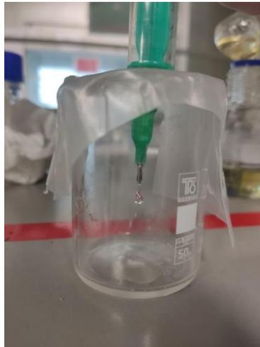
Figura 9. Imagen del proceso de deposición de gotas de las disoluciones en el interior del recipiente sellado.
