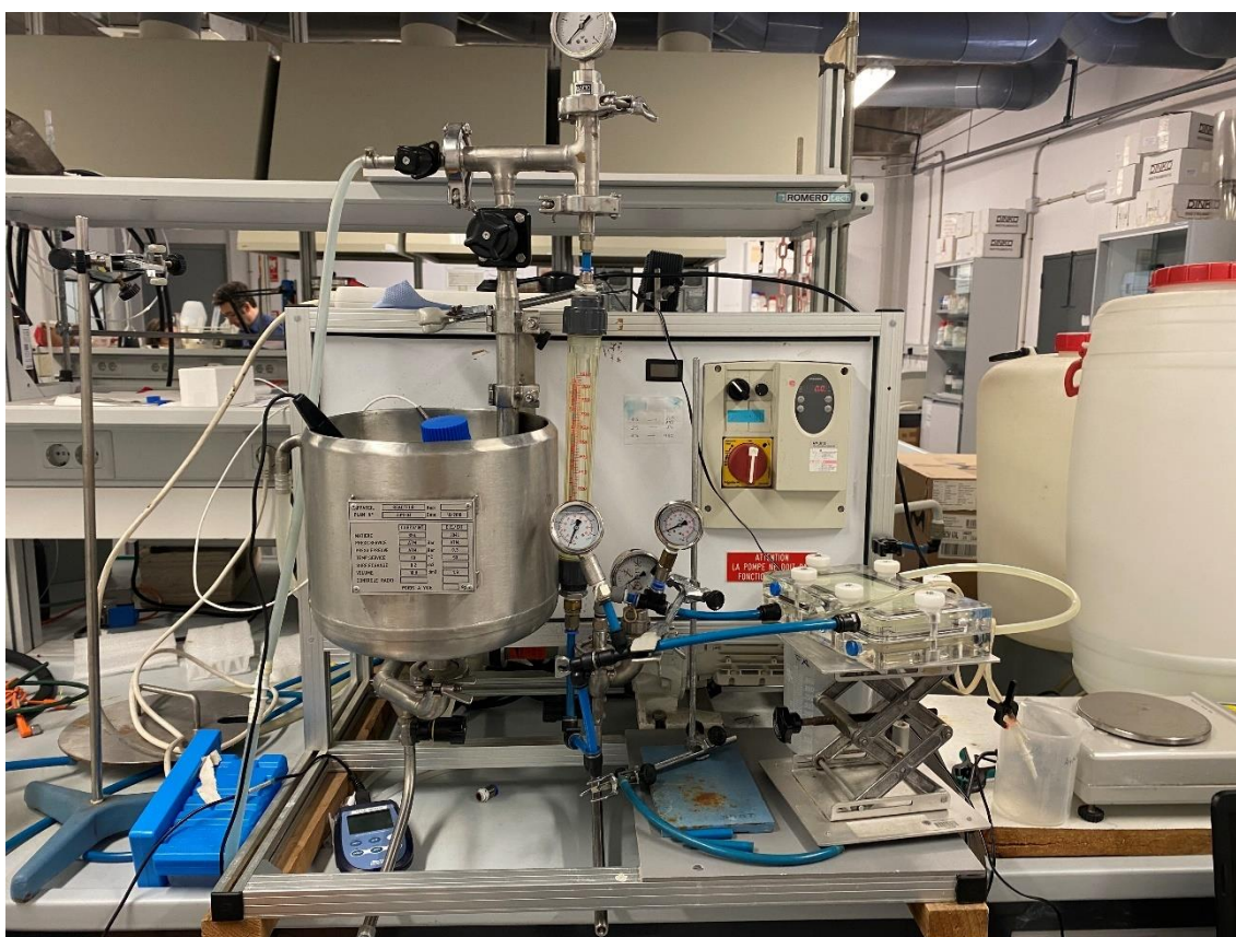
Figura 6. Planta de ultrafiltración.
