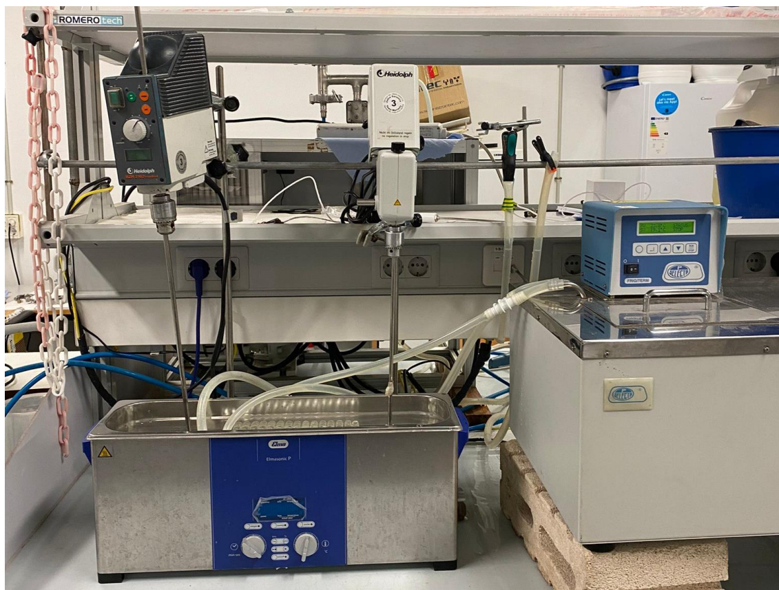
Figura 5. Sistema de extracción sólido líquido asistido por ultrasonidos.
