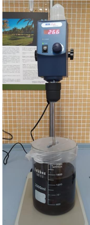
Figura 71. Agitación de la mezcla mediante el agitador de palas
