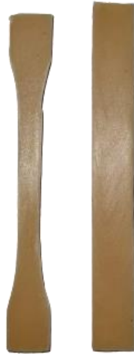
Figura 17. Probetas para caracterización mecánica.
