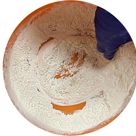
Figura 14. Plastificación mecánica del almidón.
