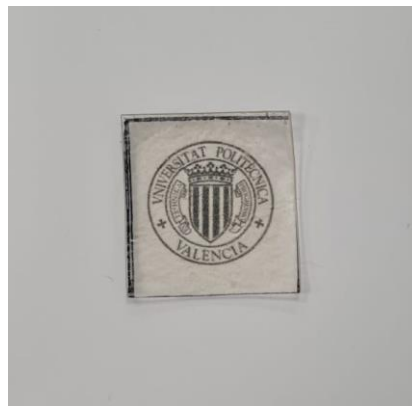
Figura 20. Film obtenido en el moldeo por compresión.
